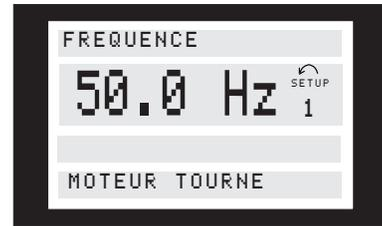
La ligne 2 indique la valeur d'une variable d'exploitation avec l'unité correspondante et la ligne 1 indique un texte qui explique la ligne 2. Dans cet exemple, la fréquence a été sélectionnée comme variable par l'intermédiaire du paramètre 009. En fonctionnement normal, une autre variable peut être lue immédiatement par l'intermédiaire des touches [+/-].
